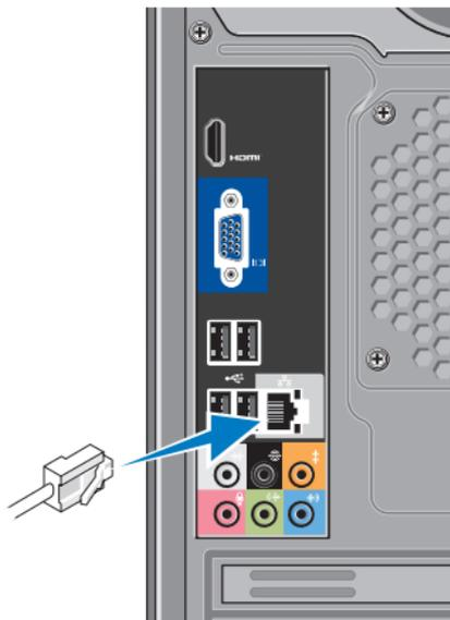
網路連線對於完成電腦的安裝不是必需的，但是，如果您具有使用纜線連接 (例如家用纜線數據機或乙太網路插孔) 的現有網路或網際網路連線，則可以立即連線到網路。請僅使用乙太網路纜線 (RJ45 連接器)。請勿將電話線 (RJ11 連接器) 插入網路連接器。
